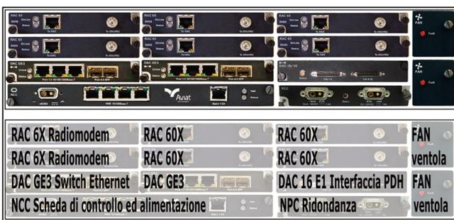
Figura 3 Schema INU in configurazione 3 link ridondati.
