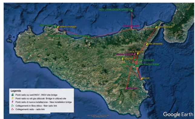
Su ogni tratta è garantita una larghezza di banda tale da consentire almeno il trasporto di trame Ethernet con velocità superiore a 100 Mbps su canali RF di larghezza pari a 28 MHz.
