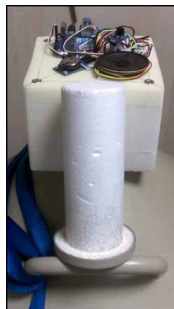
Figura 7 Corpo isolante. In primo piano si vede il vecchio tappo originale appoggiato (capovolto) sulla maniglia del dewar. Dietro c'è il corpo isolante del nuovo tappo avvolgente già inserito sull'imboccatura del dewar. Sopra si vede l'elettronica di controllo (Arduino Yùn) con il piccolo altoparlante per l'allarme in sito.
