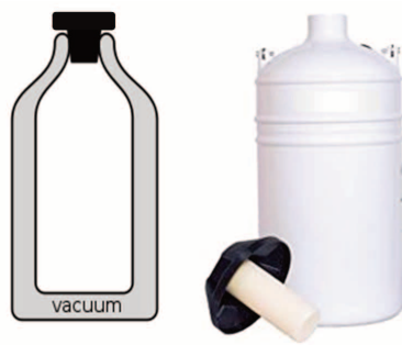
Figura 1 Vaso di Dewar visto in sezione e nel suo aspetto esteriore. In basso il suo tipico tappo a forma di fungo.
