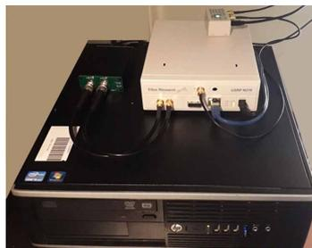
Figura 11 Trasmettitore ionosonda SDR.
