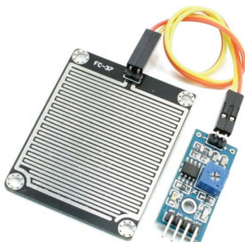
Figura 24 Sensore per la rilevazione della pioggia e della neve, costituito dalla scheda di rilevazione (sinistra) e dalla scheda di controllo (destra).
