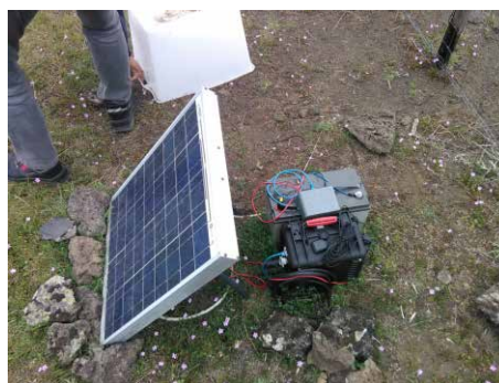
Figura 21 Installazione della stazione mobile con GAIA2 e router UR5i per esperimento a Piano dei Grilli, Bronte (Etna) (09/04/2018).
