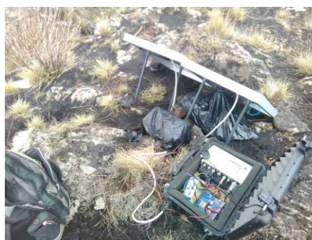
Figura 22 Installazione di una stazione mobile OEM con Nanometrics Taurus e router UR5i (11/09/2019).
