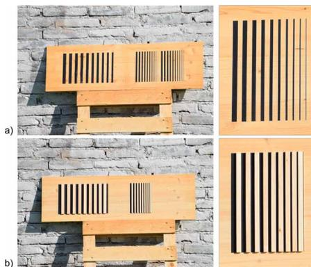
**Figura 1** a) Target 2D: pannello di legno con le strisce nere da misurare; b) target 3D: pannello di legno con le strisce nere da misurare intervallate da dei listelli aventi spessore pari a 1 cm.
