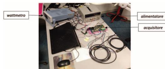
**Figura 3** Banco di misura per la potenza elettrica assorbita con acquisitore INGV GAIA2.
