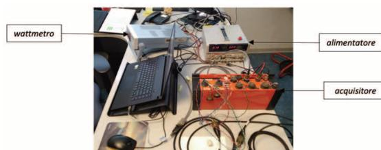
**Figura 4** Banco di misura per la potenza elettrica assorbita con acquisitore Quanterra Q330.
