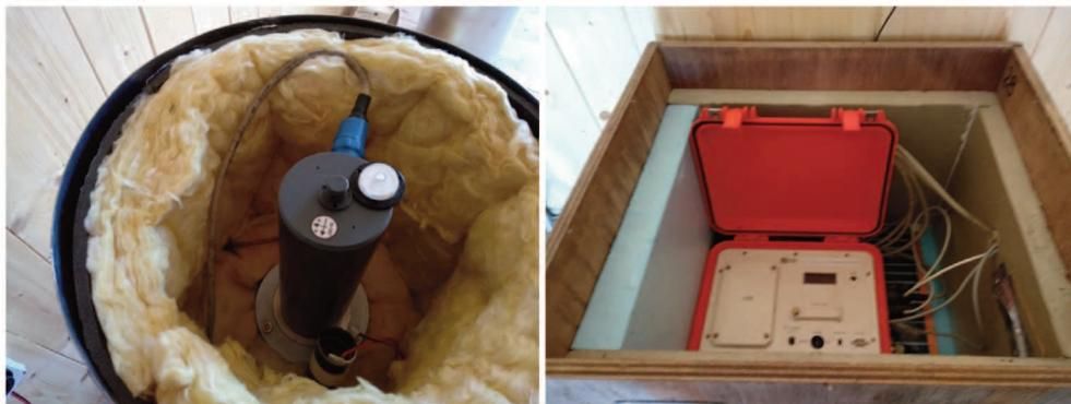
**Figura 4** Il sensore (a sinistra) e l'elettronica (a destra) del magnetometro LEMI con la nuova coibentazione e il sistema di termostatazione.
