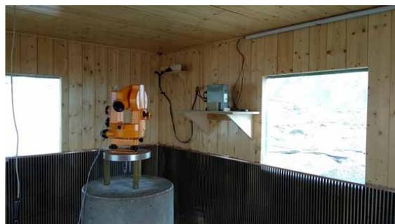
**Figura 5** Strumenti magnetici nello *shelter* misure assolute. In alto l'interno dello *shelter* dove è visibile il magnetometro scalare. Al centro il teodolite per le misure assolute e in basso, lungo le pareti, il film riscaldante.
