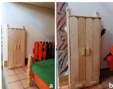
**Figura 42** Particolare dell'armadio fissato a parete con chiodi da muro a) prima del terremoto b) dopo il terremoto.
