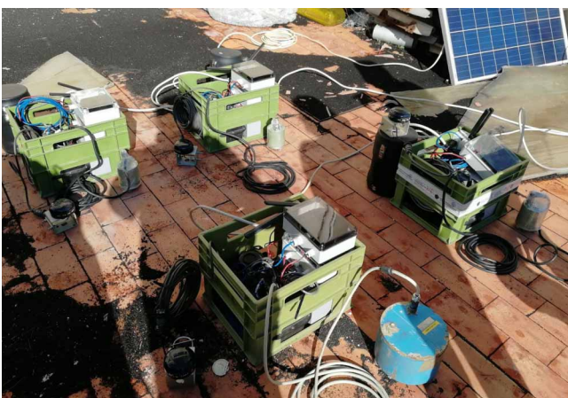
Figura 2 Huddle test , foto della strumentazione installata presso la sede dell'OE a Nicolosi (CT).
