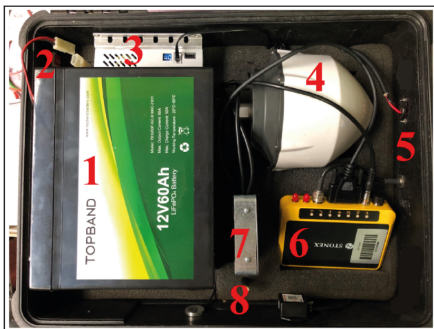
Figura 21 Layout del KIT litio: 1 = batteria, 2 = interruttore, 3 = regolatore di carica, 4 = antenna Callian, 5 = connettori, 6 = ricevitore, 7 = interfaccia telemetria, 8 = modulo bluetooth e sensore temperatura.
