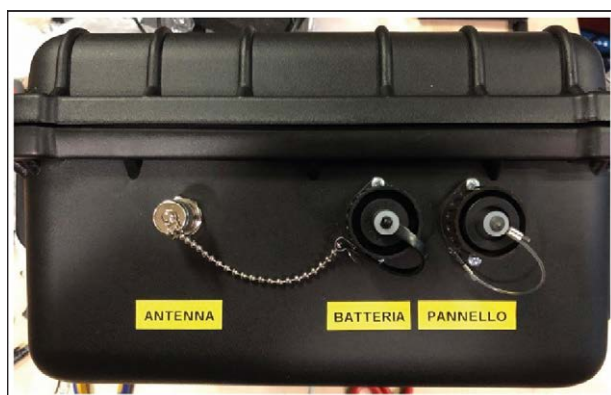
Figura 6 Vista generale dei connettori con i relativi tappi chiusi ed etichette.
