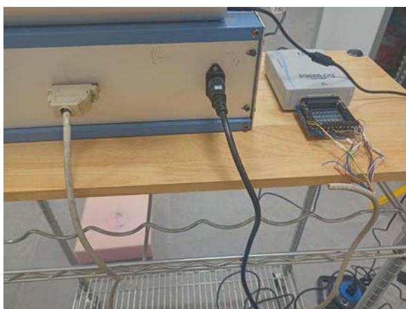
Figura 23 PicoLog 1216 collegato attraverso morsetti al connettore DB25 sul retro del subrack .
