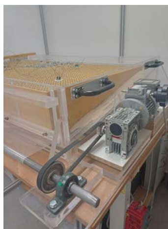
Figura 21 Accelerometri posizionati sulla superficie del cuneo di gommapiuma e puleggia che muove il telo di nylon.
