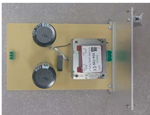
Figura 20 Scheda dell'alimentazione. Figure 20 Power supply board.
