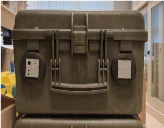
Figura 3 Lato destro della valigia con passacavi con innesti multi-foro.
