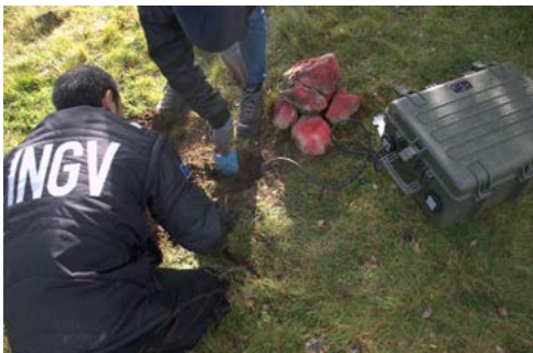
Figura 7 Dettaglio dell'installazione sul campo dell'array sismico.
