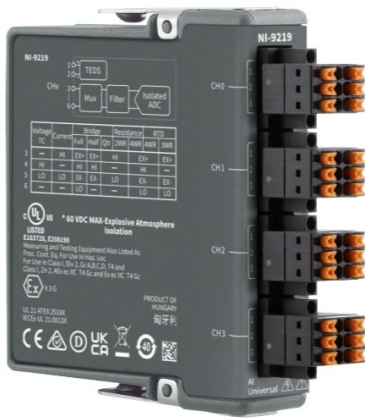
Figura 3 Il modulo NI-9219 per l'acquisizione dei segnali analogici per la calibrazione dei sensori.
