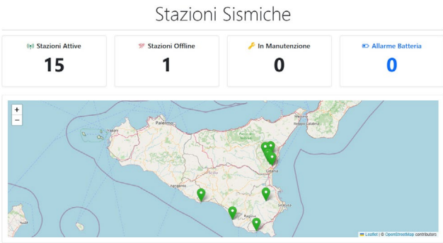
Figura 9 Dashboard operativa. La schermata principale che integra i KPI di stato (“Stazioni Attive”, “Offline”, “In Manutenzione”) e la mappa geospaziale interattiva basata su Leaflet.js per la localizzazione immediata delle anomalie.
