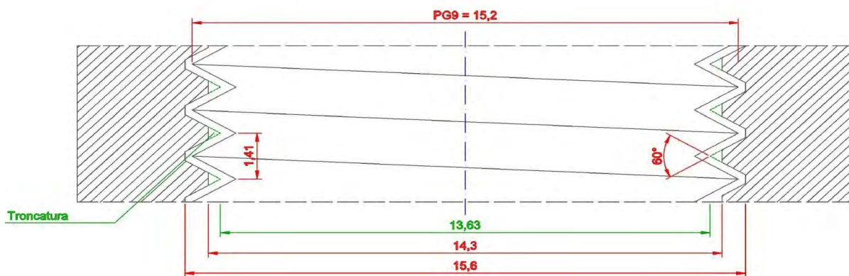
Figura A2 Sezioni della filettatura del pressacavo (centro) e del cappuccio (campitura). Figure A2 Sections of cable gland (center) and shell threads (crosshatch).
