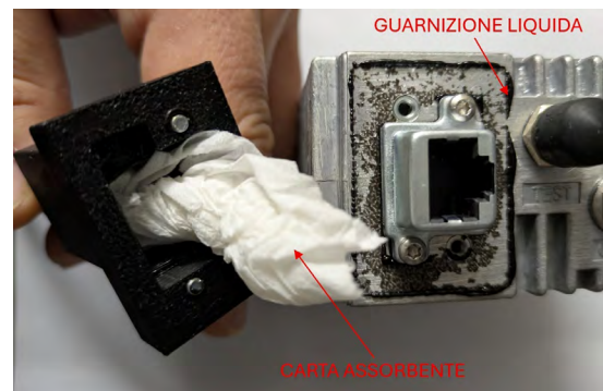
Figura 16 Risultato del test di infiltrazione. Figure 16 Infiltration test result.
