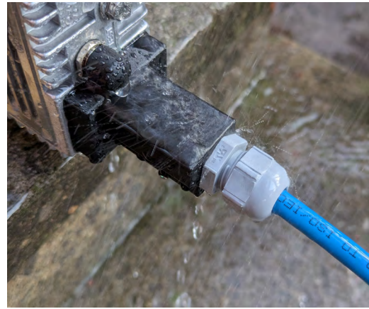
Figura 15 Prototipo sottoposto al test di infiltrazione. Figure 15 Prototype under infiltration test.
