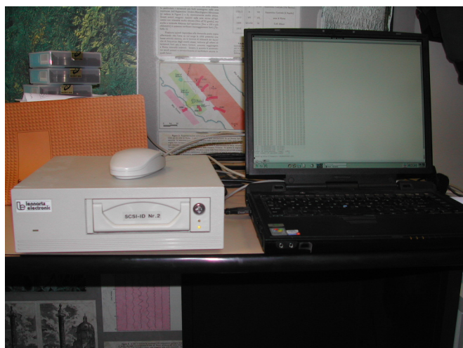
Figura 3. Particolare del lettore Hard disk per gli acquisitori MarsLite collegato attraverso la porta scsi a un pc/linux.
