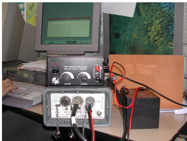
Figura 1. Particolare del disco Reftek collegato con la workstation SUN. Il disco è alimentato da una batteria a sua volta connessa ad un alimentatore.
