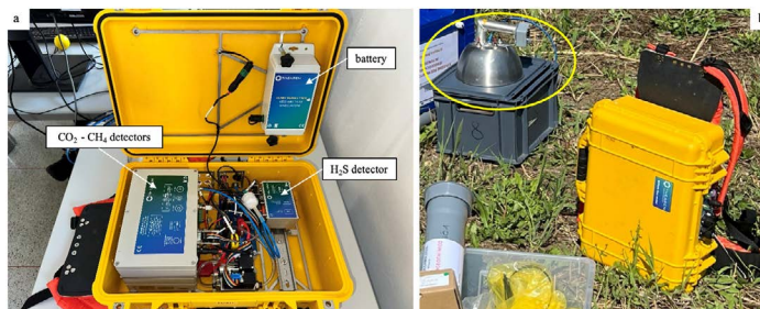
Figura 18 a) Configurazione interna del flussimetro portatile; b) flussimetro portatile con camera di accumulo (cerchiata in giallo) per il convogliamento dei gas del suolo al sensore.
