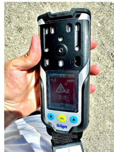
Figura 15 Dräger in modalità di misurazione sul campo, con allarme A2 attivato dalle emissioni di H_2S .
