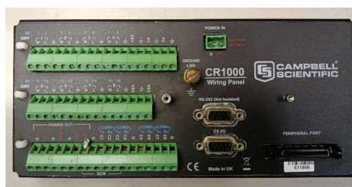
Figura 1 Il CR1000 di Campbell Scientific è uno dei data logger più utilizzati al mondo per l'acquisizione dati, il controllo e il monitoraggio ambientale [1].
