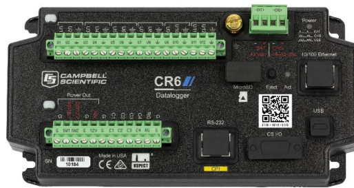
Figura 2 Il Campbell Scientific CR6 è un sistema di acquisizione dati (data logger) ad alte prestazioni, flessibile e robusto, progettato per il monitoraggio ambientale, industriale e infrastrutturale [2].
