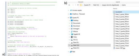
Figura 12 Esportazione della nuvola di punti dal DEM: a) interfaccia DigMap per il salvataggio; b) nuovo file (nuvola.txt) salvato nella cartella contenente tutte le coordinate. Figure 12 Exporting the point cloud from the DEM: a) DigMap interface for saving; b) TXT file containing all coordinates.
