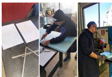
Figura 3 a) Progetto delle sezioni; b) taglio del pannello di polistirene; c) taglio dei cerchi di polistirene.
