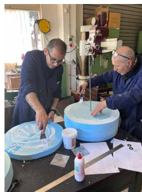
Figura 4 Mano di fondo riempitivo applicabile a spatola.
