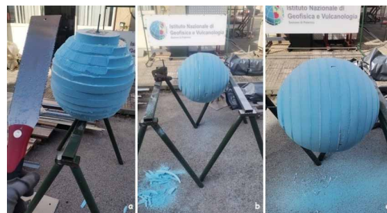
Figura 5 a) Realizzazione iniziale della sfera; b) tornitura e levigatura; c) forma sferica finale.
