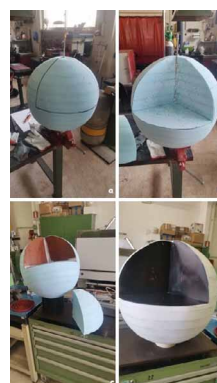
Figura 6 a) Disegno della sezione; b) taglio della sezione; c) rivestimento della sezione; d) verniciatura della sezione.
