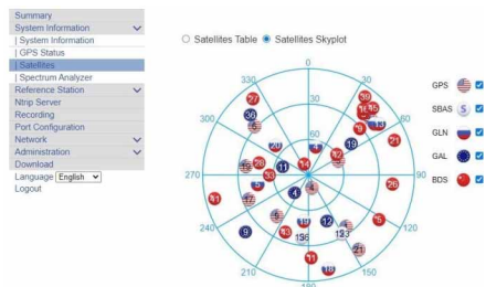
Figura 7 Skyplot costellazioni GNSS: ogni costellazione è rappresentata con la bandiera del paese di appartenenza (GPS – USA, GLONASS – Russia, GALILEO – EU, BEIDOU – Cina). Figure 7 GNSS constellation skyplot: each constellation is represented with the flag of the country it belongs to (GPS – USA, GLONASS – Russia, GALILEO – EU, BEIDOU – China).
